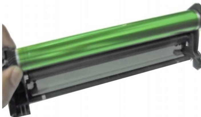
Установите крепление и зафиксируйте его винтом.
