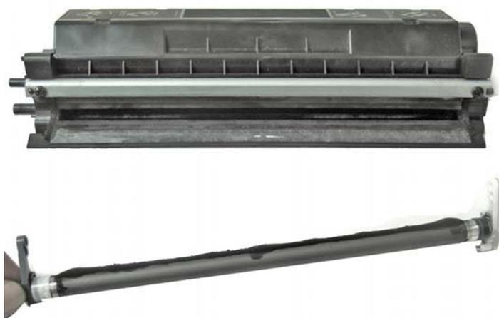
Откручиваем два винта и снимаем лезвие подбора.
