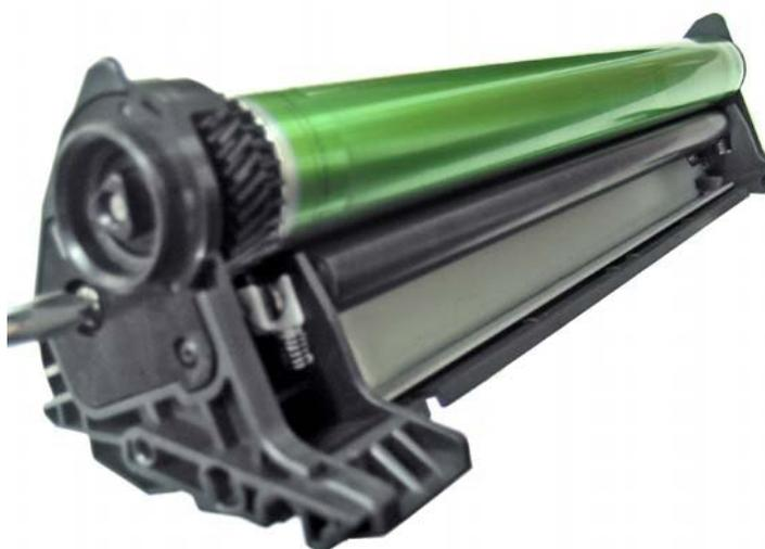
Теперь удалите крепление, фотобарабан и ролик заряда.
