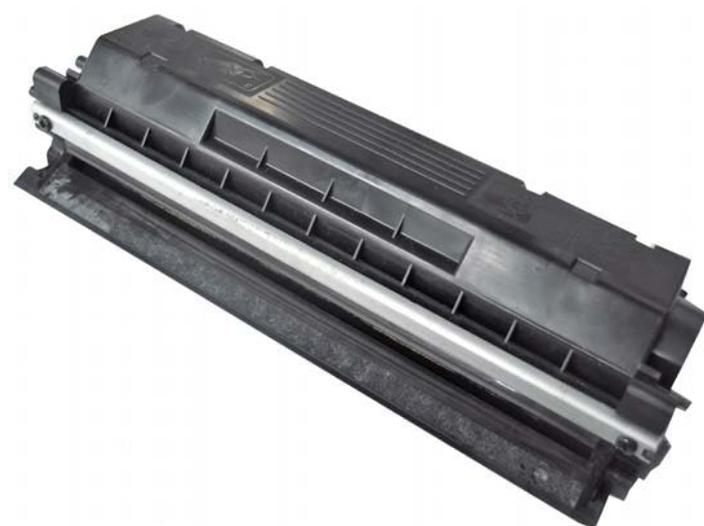
Ставим наместо вал переноса, предварительно очистив его сухой чистой тряпкой, шестерни и правую крышку.
