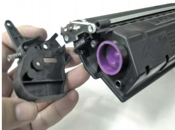
Снимаем вал переноса.
