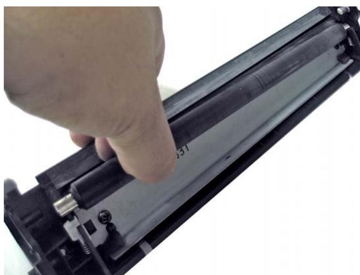
Открутите два винта и снимите лезвие очистки.
